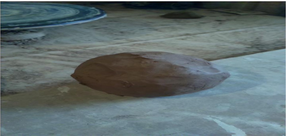
ثم يبدأ فى التكوير كالصلصال حتى يصبح جاهز لعمل الأشكال الفخارية بواسطة ما يسمى "بالدولاب"
